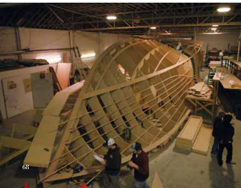
縦フレームやコールドモールドのハルを支える骨組み。カロライナフレアからタンブルフォームに繋がる丸みを帯びた美しいハルライン。ハルの積層を始める前、すでに芸術品の品格を持つ。
